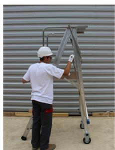
Rabattre le garde-corps sur l'avant de la plate-forme dévisser l'extrémité de chaque poignée (côté du plan de montée) à l'aide d'une clé allen et les placer à la verticale
